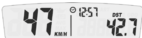
Display 1: Geschwindigkeit, Uhrzeit, DST 1
