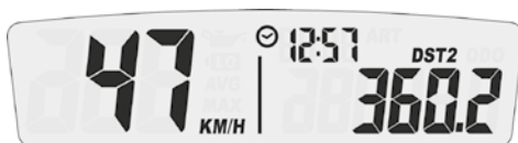
Pantalla 2 : Velocidad, Hora, DST2
