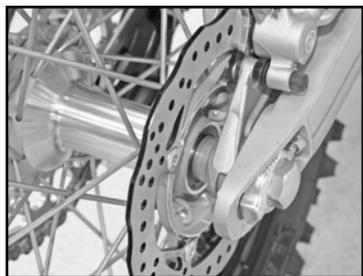
Positionner les tendeurs de chaîne ❶ et installer l'écrou ❷ mais ne pas serrer.
